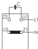
Le seguenti serie sono disponibili con un motore monofase da 0,320 kW, 1 ~230 V 50 Hz o 0,365 kW, 1 ~230 V 60 Hz:
