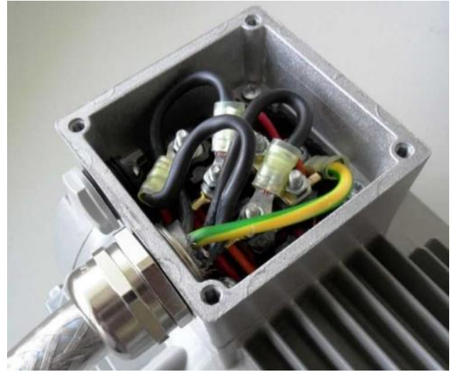
Fig. 20: Cablaggio nella cassetta di connessione motore
