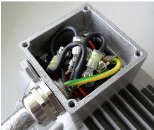
Fig. 16: Cablaggio nella cassetta di connessione motore
