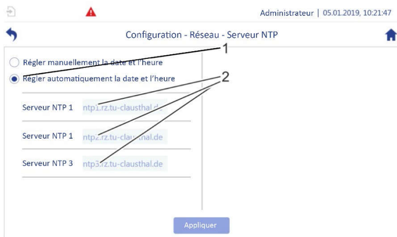
Fig. 169: « Configuration - Réseau - Serveur NTP »
