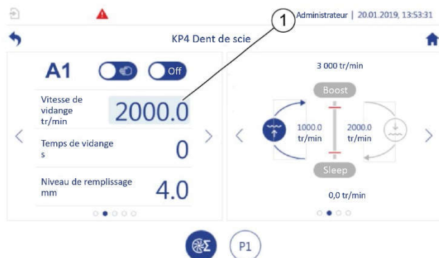
Fig. 62: Mode cadencé en dents de scie – Vidange
