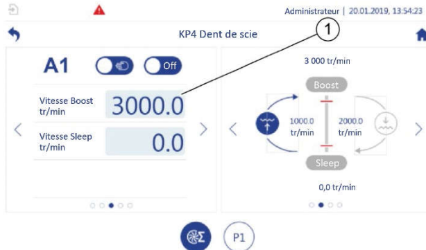
Fig. 61: Mode cadencé en dents de scie – Boost
